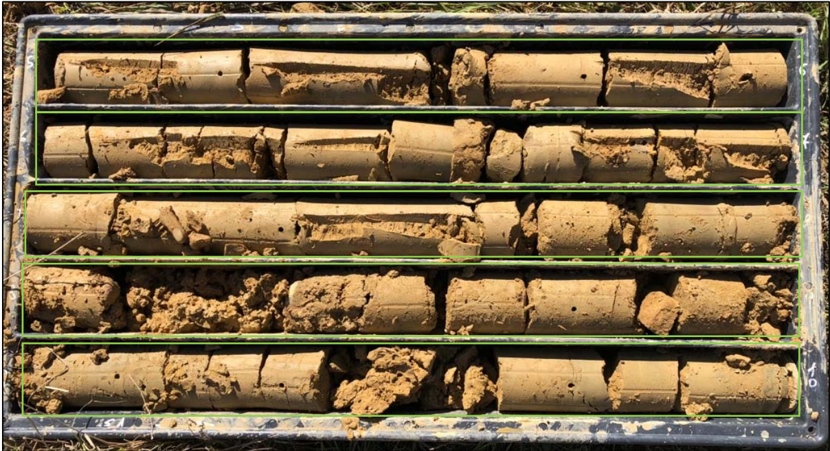
Fig. 5 - Foto del sondaggio a carotaggio continuo eseguito in situ
