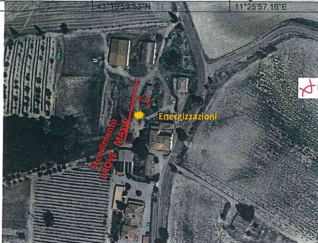
Figura 1 - ubicazione stendimento sismico e punti di energizzazione per le prove MASW in oggetto
